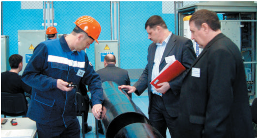
Проверка качества изоляционного покрытия выполняется на образцах труб Ду 300мм
