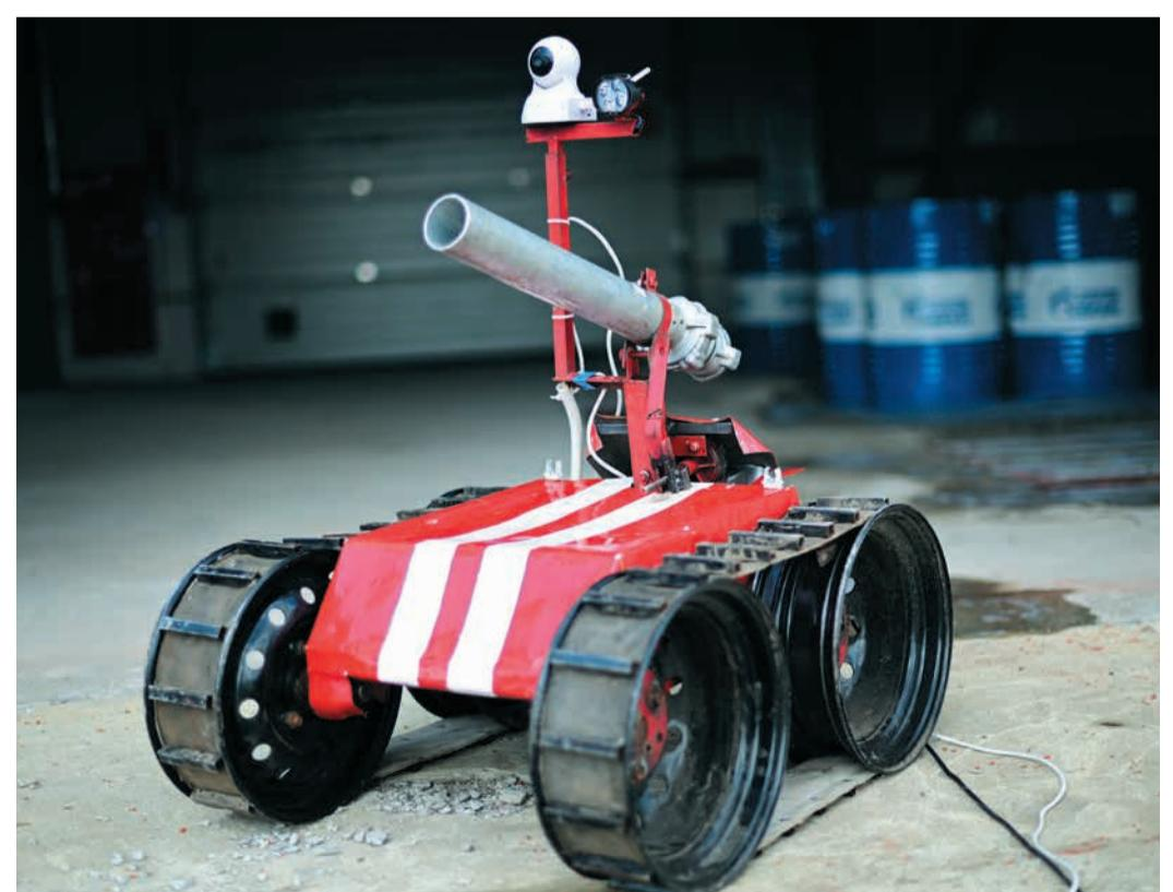
гу возгорания, условно обозначенному красным флагом, и ликвидирует имитацию пожара мощным потоком пены.
